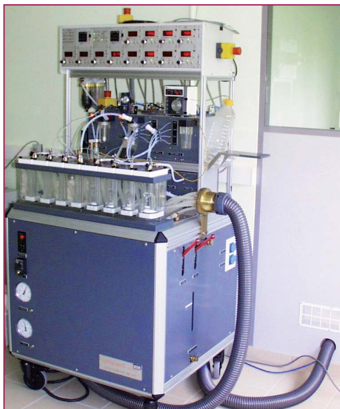
L'olfactomètre, appareil détectant et analysant les odeurs
